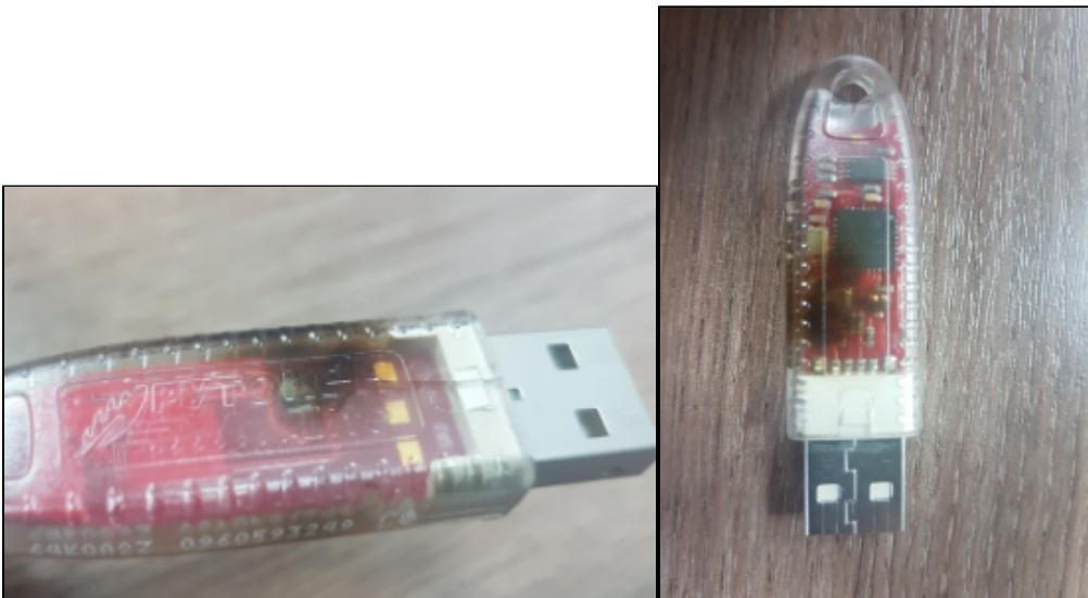
Рутокен со следами оплавления и/или почернения можно направить на дополнительную экспертизу. Если в ходе экспертизы будет выявлено умышленное повреждение или превышение допустимого напряжения, подаваемого в USB-порт, гарантийная замена Рутокена на новый произведен не будет.
